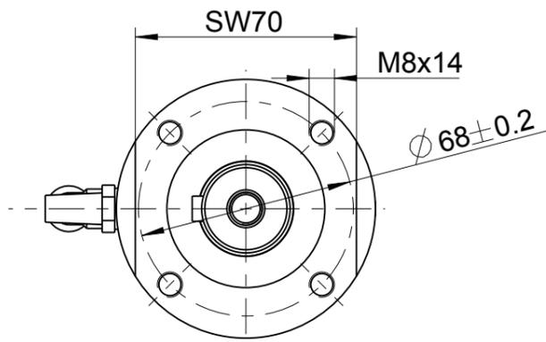
Steuerluftanschluss für Motorbremse
