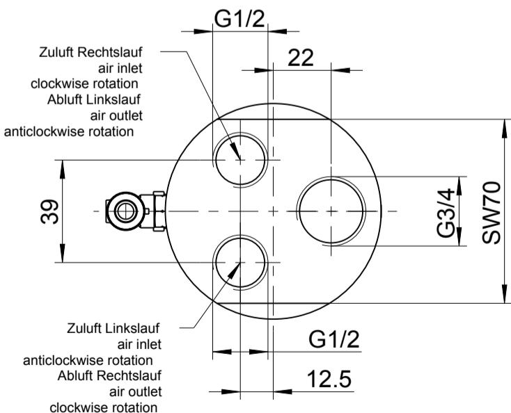
Schalldämpfer-Set für Rechts- oder Linkslauf
