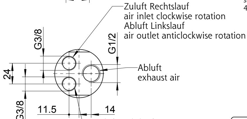
Schalldämpfer-Set für Rechts- oder Linkslauf
